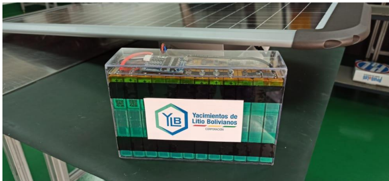
Prototipo de paquete de batería de 12.8V -30Ah LFP para aplicación en luminarias solares de 60W.
