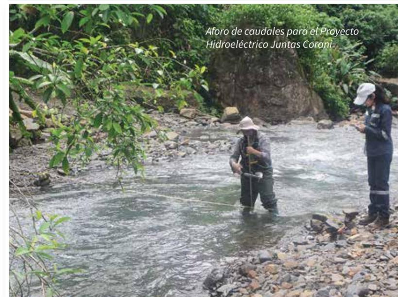
*Aforo de caudales para el Proyecto Hidroeléctrico Juntas Corani*
