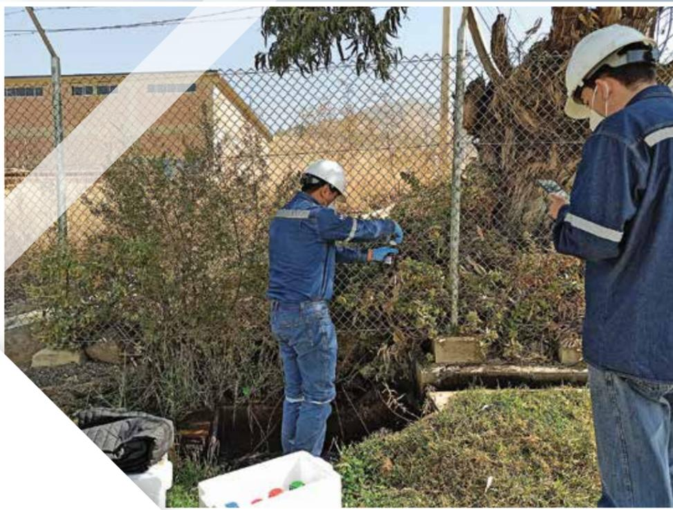
*Toma de muestra de agua turbinada en la Central Hidroeléctrica Mísicuni, para garantizar su calidad en la dotación para riego*
